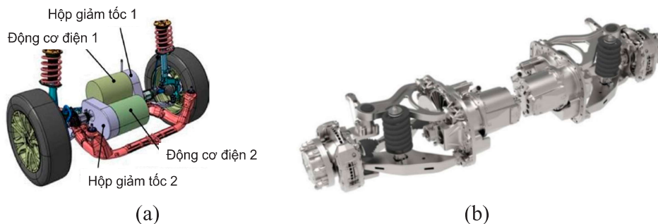
Hình 10. Hệ thống động lực 2 động cơ điện
