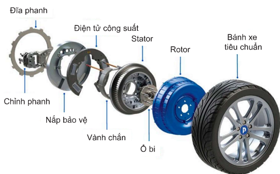
Hình 11. Hệ thống động cơ điện tích hợp vào bánh xe
