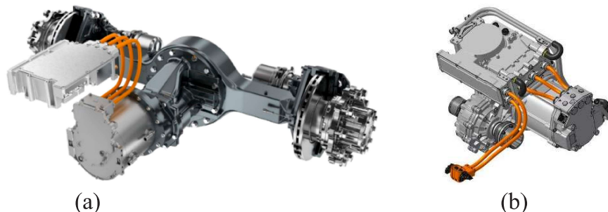
Hình 9. Hệ thống động lực một động cơ điện trong thực tế
