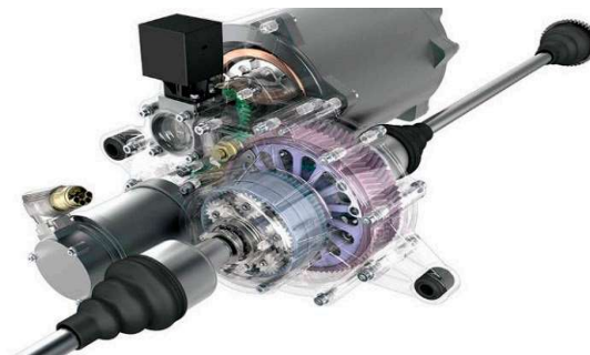
Hình 18. Cụm cầu kiểu hành tinh có cơ cấu phân bố mô men
