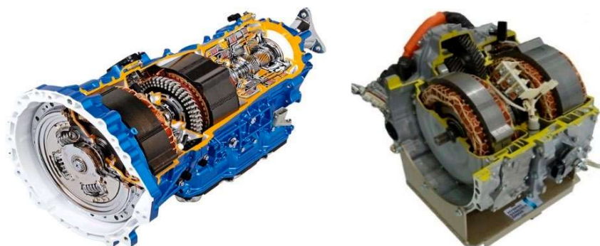
Hình 14. Hộp số hybrid với hai mô tơ máy phát điện kết hợp với các bộ truyền hành tinh
