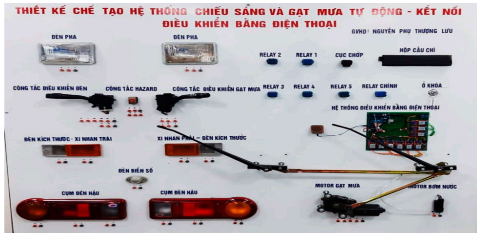
Hình 8. Ứng dụng mô hình hệ thống chiếu sáng tín hiệu điều khiển bằng điện thoại
