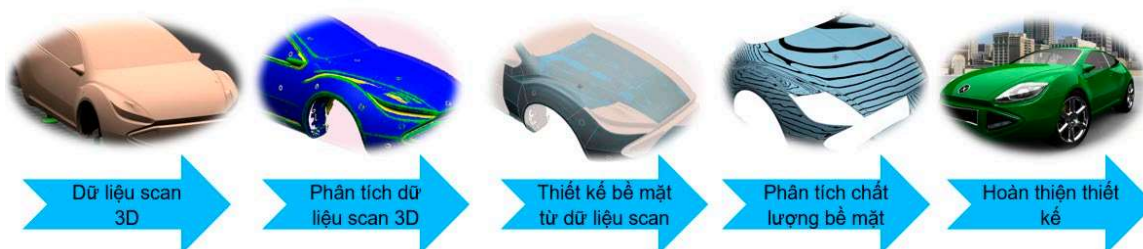
Hình 12. Quy trình thiết kế ngược kiểu dáng xe trên phần mềm NX
