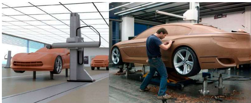
Hình 10. Tạo mô hình đất sét xe bằng máy CNC và thủ công
