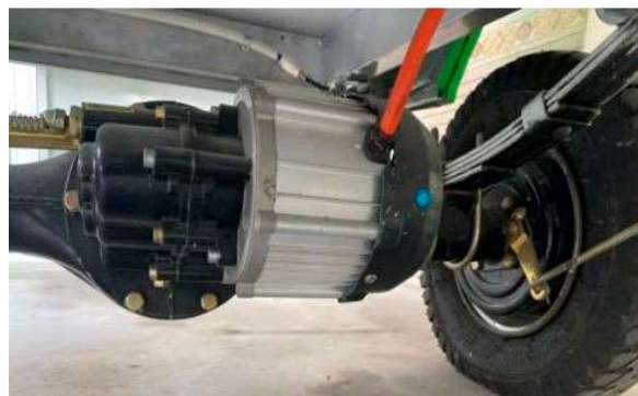
Hình 8. Động cơ điện
