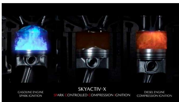
Hình 3. Động cơ Skyactive X (HCCI) so với động cơ xăng và diesel
