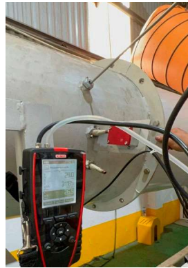
Thiết bị đo lưu lượng ống pitot và cảm biến đo tốc độ gió
